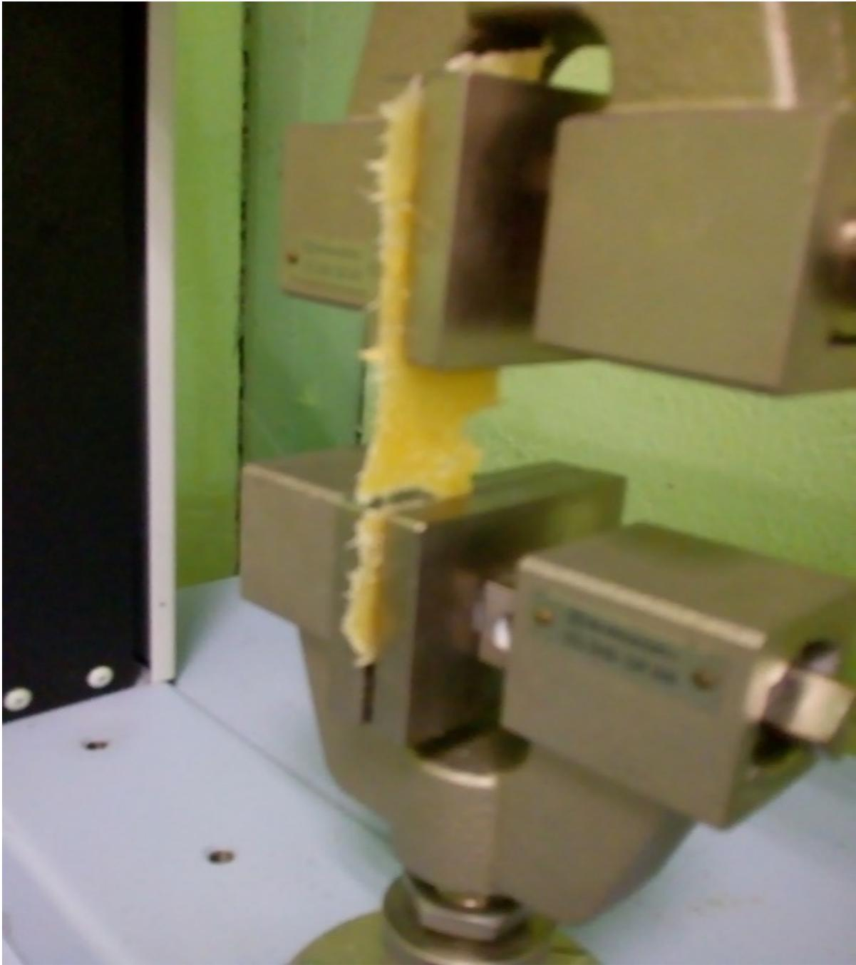
***Figura 3.12. Pruebas de esfuerzo de tensión para determinar la resistencia de las mezclas.***
