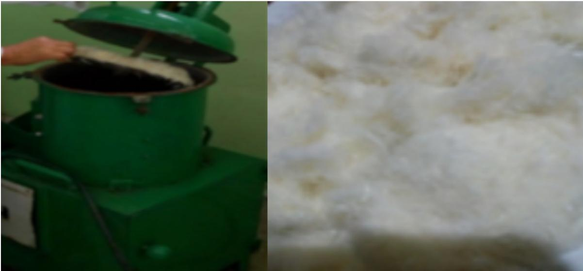
**Figura 3.4 Plumas trituradas con la trituradora mecánica.**
