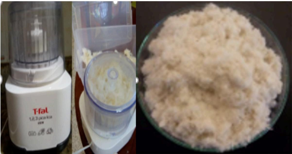
**Figura 3.5. Plumas trituradas con la picadora Moulinex.**
